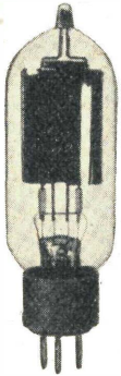
Lampada al neon Rectron. Tipo a campo luminescente per ricevitori a disco.
